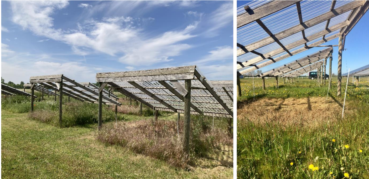
Abb. 1: Aufnahme links: Dachkonstruktionen, die Wasser von den Versuchspartzen ableiten und dadurch den Niederschlag um 55 % reduzieren. Aufnahme rechts: Auswirkungen der experimentellen Trockenheit unter den Dächern auf die Vegetation im Frühjahr 2021.
