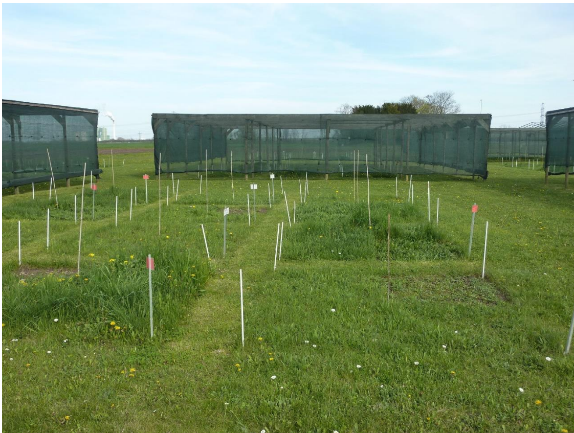
Versuchsanlage DivResource mit schattierten und unschattierten Blöcken (Mai 2023) und den in vier Flächen unterteilten Versuchspartzellen
